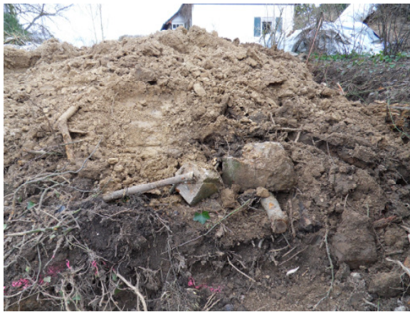
Bild 4: Unterboden auf Oberboden, vermengt mit Bauschutt
