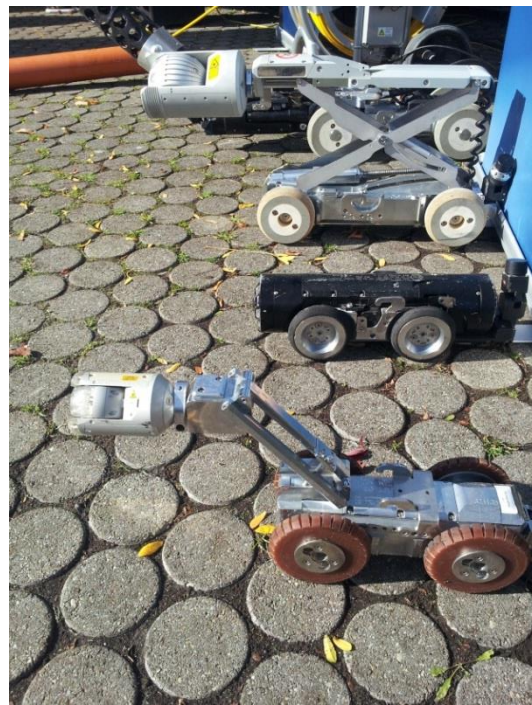
Abbildung 7.3 - IBAK Lite-System (links) und diverse Kameraroboter (rechts)
