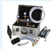
Dichtheitsprüfkoffer für Hausanschluss-Leitungssysteme
