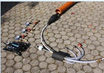
Prüf- und Schubblase mit Anschlüssen und Prüfköpfen
