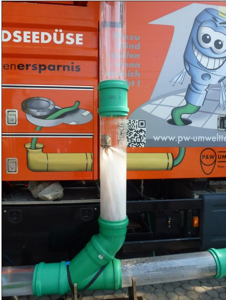
Abbildung 34 - Spüldüsenkopf mit Kamera in Aktion
