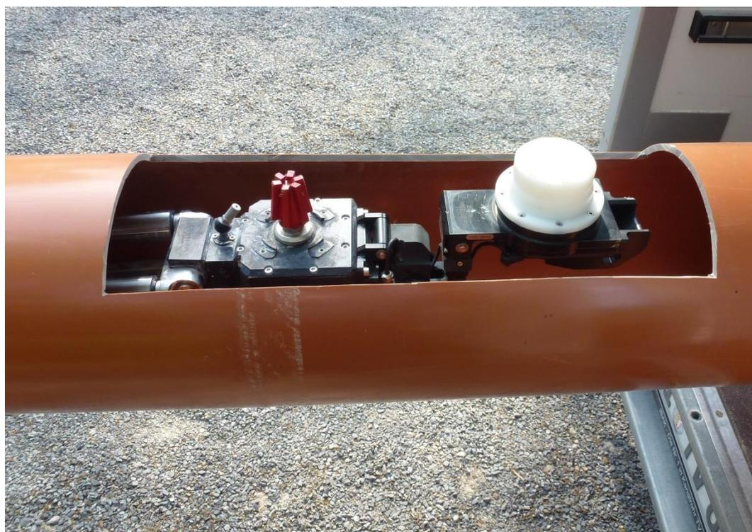
Abbildung 23 - IBAK Fräsroboter mit Lateral-Detektor
