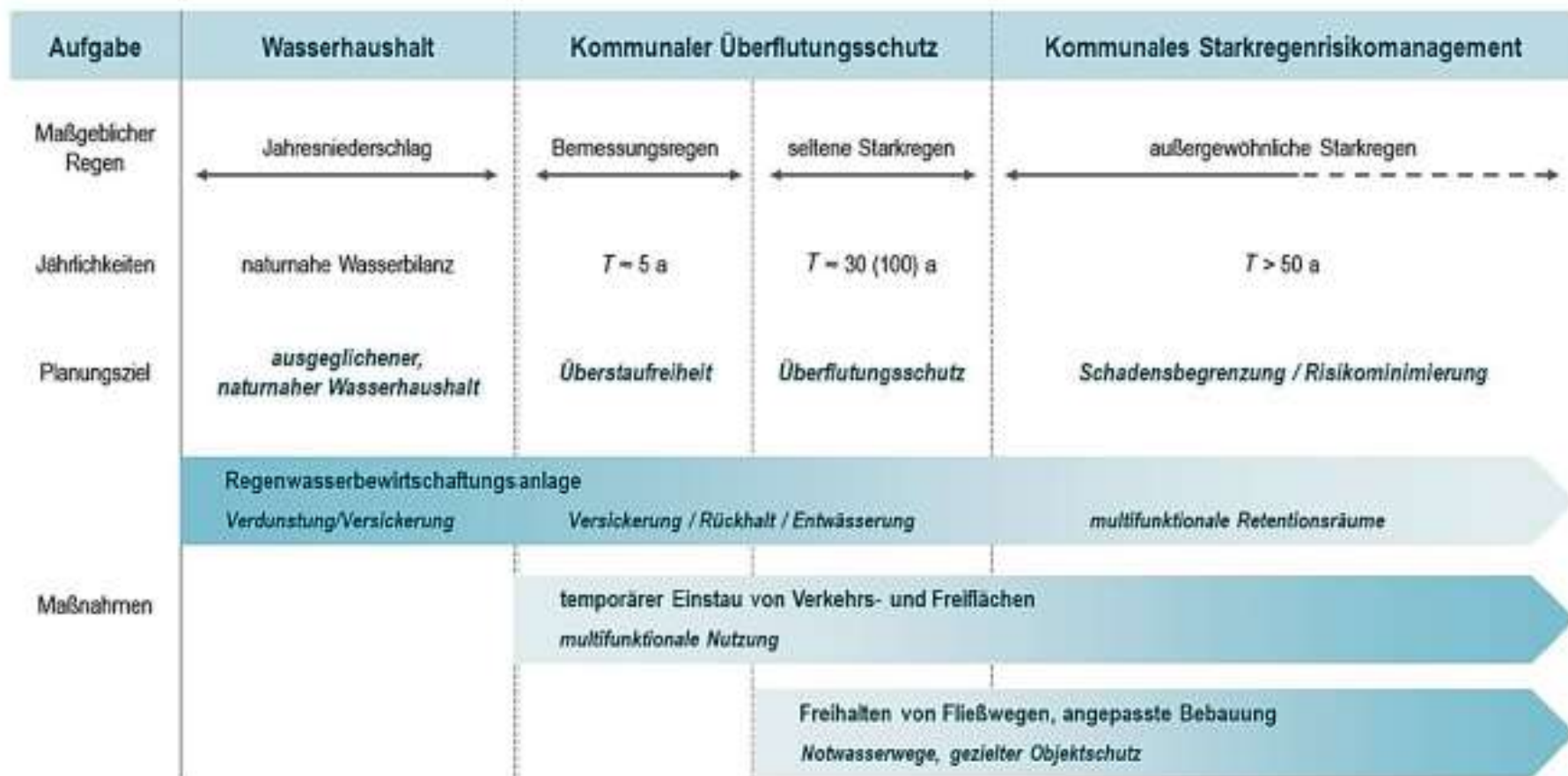
Bild 1: Potenzial von Versickerungsanlagen auf die Wasserwirtschaft in Siedlungsgebieten (Quelle: Merkblatt DWA-M 119:2016 ergänzt) (Quelle: Ingenieurgesellschaft Prof. Dr. Sieker mbH)
